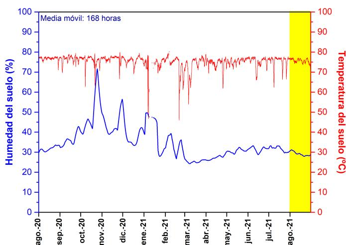
**Figura 2.2** – Variaciones temporales de la media móvil semanal relacionada con el registro en modo continuo de la humedad (azul) y la temperatura (roja) a 40 centímetros de profundidad en la estación termométrica TFT12 (Mirador de la Fortaleza del Teide, Tenerife). Los datos de agosto de 2021 se encuentran indicados por el área amarilla.
