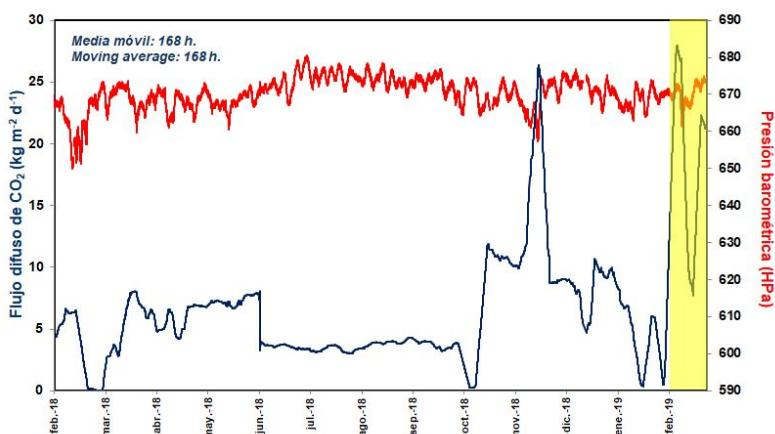
**Figura 4.2 - Monitorización de la media móvil semanal del registro en modo continuo del flujo de  $\text{CO}_2$  (azul) y la presión barométrica (rojo) de la estación geoquímica TFG12 (Mirador de la Fortaleza del Teide, Tenerife). Los datos de febrero de 2019 se encuentran indicados por el área amarilla.**
