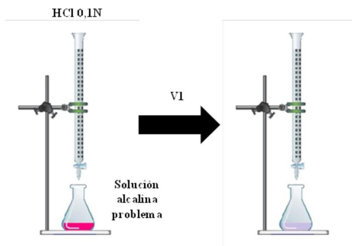
Figura 4. Esquema de la valoración con fenolftaleína.
