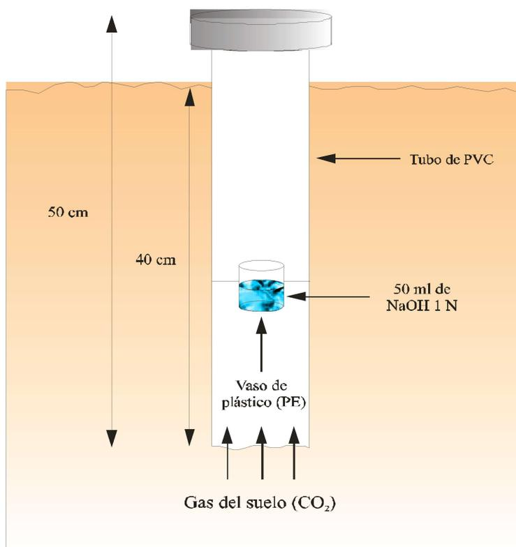
Figura 2. Diagrama de una trampa alcalina.
