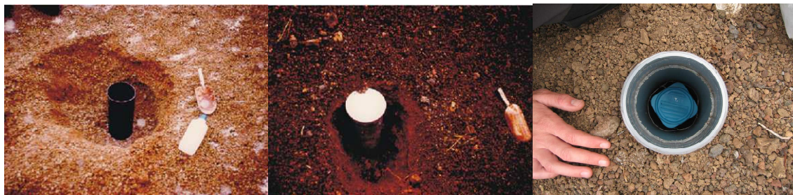
Figura 3. Fotografías de la instalación de una trampa alcalina.
